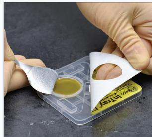
Tirer manuellement le coin inférieur droit vers l'arrière pour exposer complètement l'opercule de protection. Retirer l'opercule en tirant sur la languette et la mettre au rebut.
